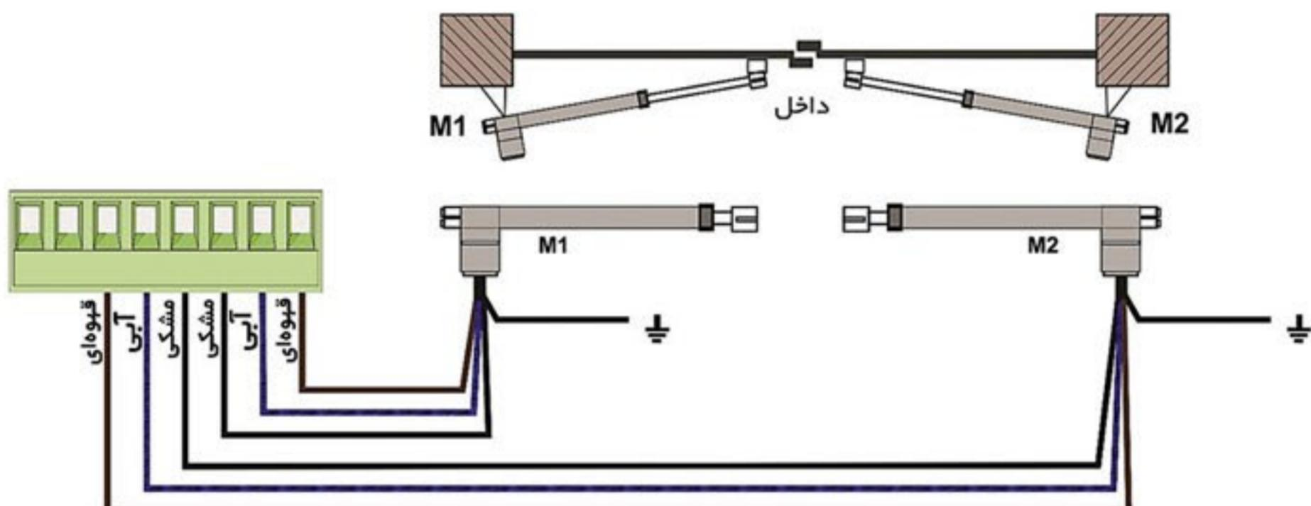
در کورس باز شدن، ابتدا موتور یک (M1) شروع به باز شدن کرده و پس از گذشت تأخیر تعیین شده توسط پارامتر **تأخير بازشو دربها**، موتور دو (M2) شروع به باز شدن می کند.
