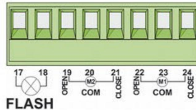
ترمینال 17 و 18 برای نصب فلاشر در نظر گرفته شده است. این فلاشر جهت ایمنی بیشتر و اعلام هشدار، در هنگام باز و بسته شدن درب عمل خواهد کرد. با توجه به منوی **حالت چشمک زدن** می‌توان خروجی این ترمینال را تنظیم کرد. در صورتی که **حالت چشمک زدن**، **بله** باشد مدار فلاشر روی برد فعال شده و کافی است به خروجی ترمینال یک لامپ 220 ولت متصل نمایید.
