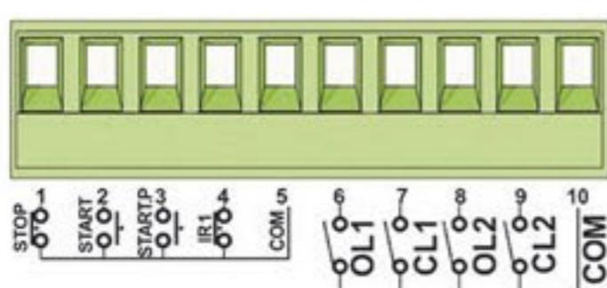
ترمینال OL1 (6 و 10) : میکرو سوئیچ انتهای کورس باز شدن موتور 1
