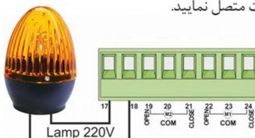
در صورتی که **حالت چشمک زدن**، **خیر** باشد خروجی فلاشر ولتاژ 220 ولت ثابت خواهد شد.
