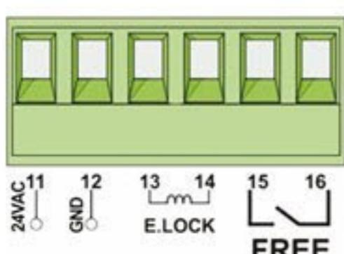
ترمینال FREE (15 و 16)، پایه‌های NO و COM رله آزاد مرکز کنترل BETTA MAX 400/600 هستند. با توجه به نوع نیاز می‌توان این رله را در حالت و زمان دلخواه، با توجه به توضیحات زیر تنظیم نمود.
