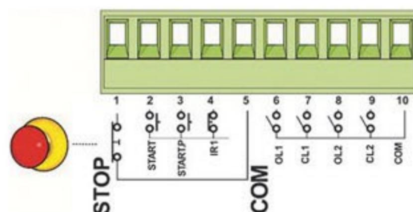
اگر در مدت زمان شمارش معکوس بسته شدن درب این شستی فشرده شود، بسته شدن اتوماتیک درب غیرفعال شده و درب در حالت توقف قرار می‌گیرد. برای بسته شدن درب باید با ریموت به سیستم، فرمان بسته شدن اعمال شود.
