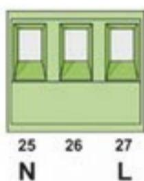
برق شهری (220VAC-50Hz) را به ترمینال‌های L و N برد کنترل متصل نمایید. پیشنهاد می‌شود یک فیوز مینیاتوری قبل از ولتاژ ورودی به برد کنترل تعییه نمایید.
