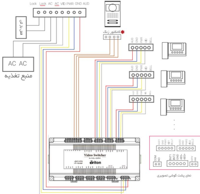
**\* توجه:** سیم مربوط به زنگ هر یک از گوشی های تصویری را از سوئیچ، به کانکتور مربوط به آن واحد در برد شستی پنل متصل نمایید.
