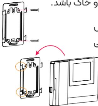
پیچ همیوپ به پایه نگهدارنده به گوشی تصویری به صورت کامل بسته شده باشد تا در صورت برخورد احتمالی جسم به زیر گوشی تصویری، از محل نصب جدا نشود.
