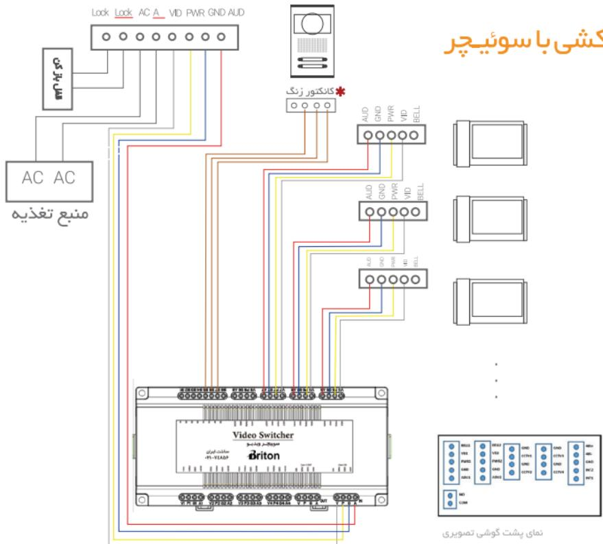
**\*توجه:** سیم مربوط به زنگ هر یک از گوشی های تصویری را از سوئیچر ، به کانکتور مربوط به آن واحد در برد شستی پنل متصل نمایید.
